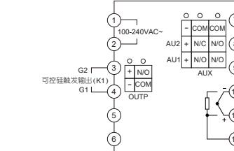
注 1: 热电偶应用补偿导线直接接入仪表后盖输入端子上, 中间不得转用普通导线连接, 并注意补偿导线型号与极性的正确。
